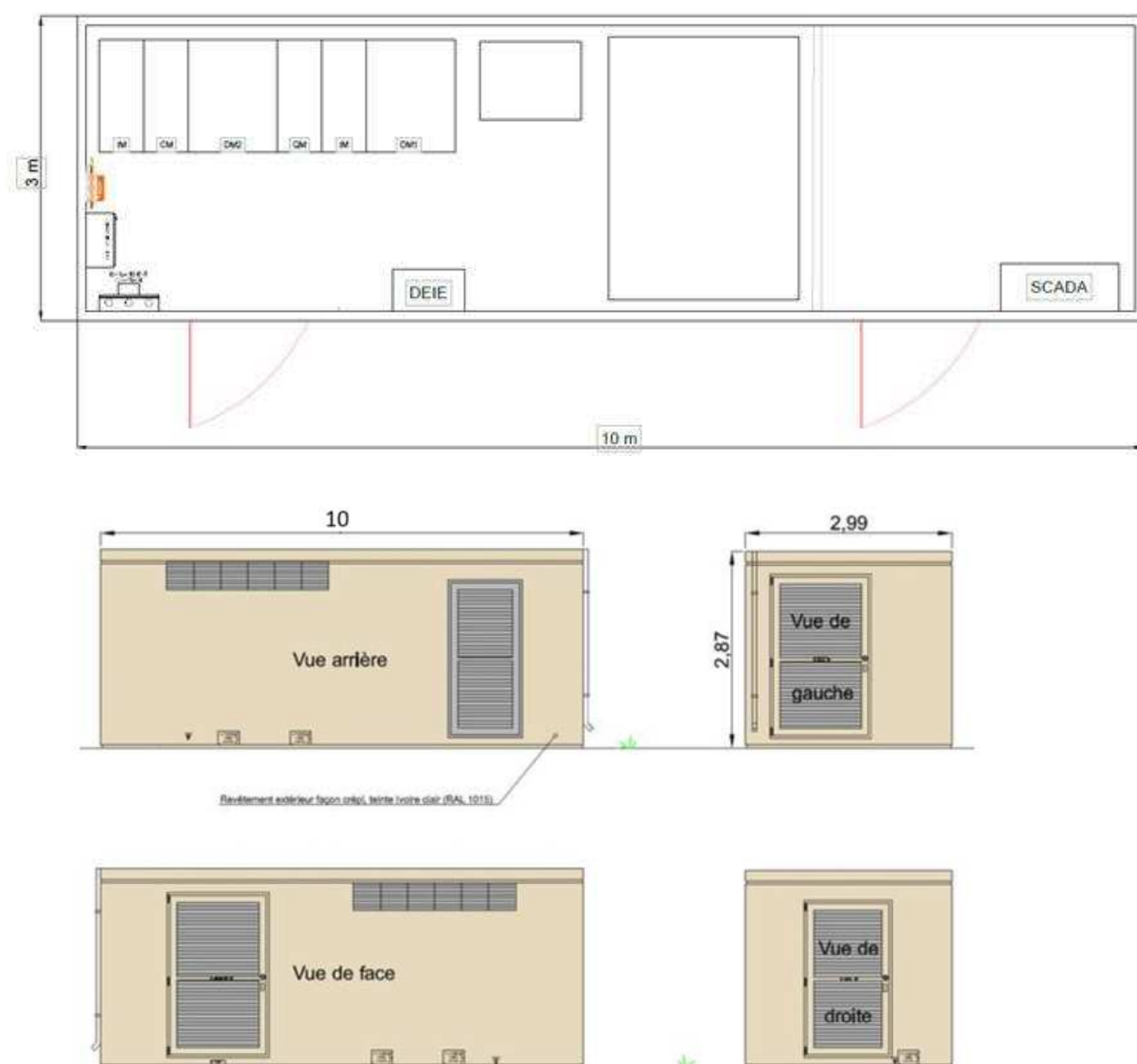
Figure 15 : Plan du poste de livraison
